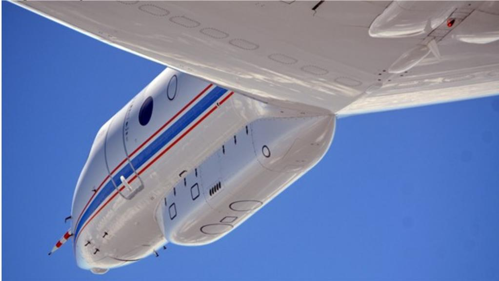
Unter dem Rumpf sowie unter den Tragflächen von HALO können zusätzlich Behälter für wissenschaftliche Instrumente befestigt werden.
