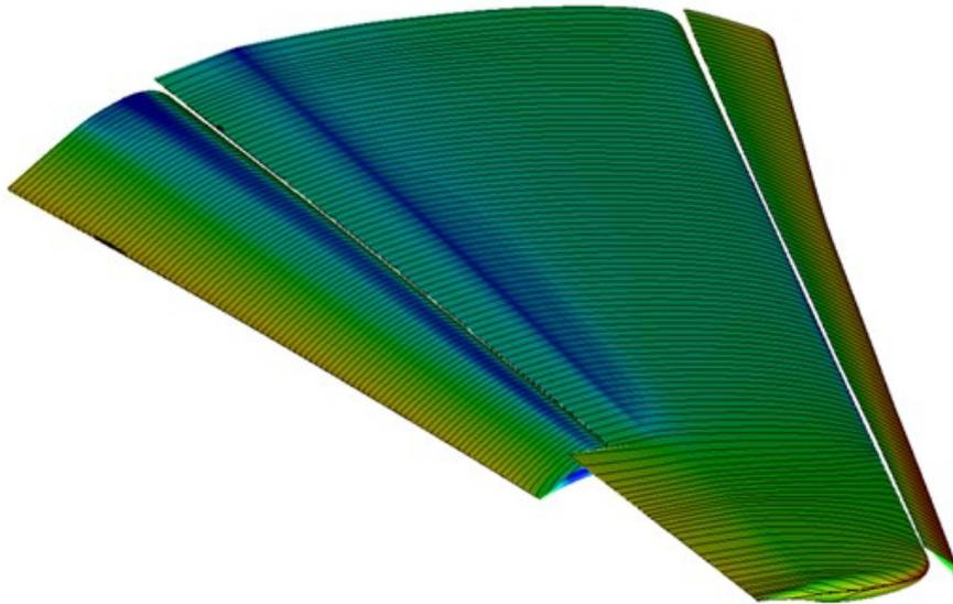
Statt ein Modell zu entwerfen, es im Windkanal zu messen und die Ergebnisse anschließend mit den am Computer durchgeführten Rechnungen abzugleichen, kehrten die Ingenieure den Entwurfsprozess einfach um: Sie bauten die neuen Klappensysteme direkt anhand der Simulationsrechnungen und überprüften sie direkt im Windkanal bei realen Strömungsbedingungen.
