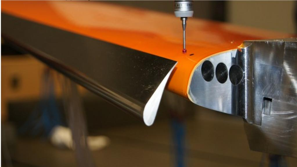
Das neu entwickelte Landeklappensystem, hält an einem zukünftigen Laminarflügel die turbulenzarme Strömung weitestgehend aufrecht.
