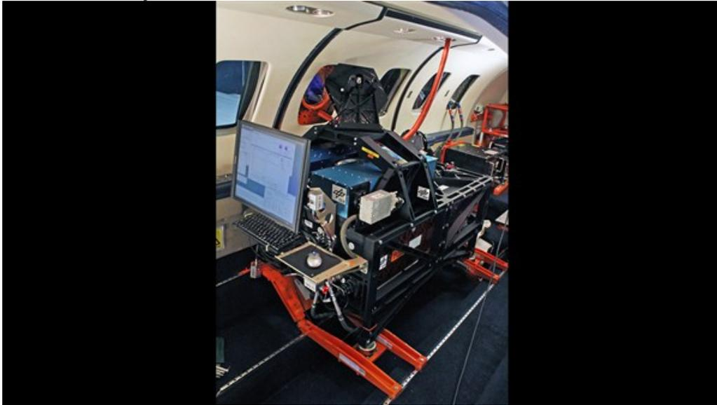
DELICAT Lidarsystem (DLR) mit Strahlführung (Thales Avionics) im Versuchsflugzeug PH-LAB (NLR): Forscher am DLR-Institut für Physik der Atmosphäre haben ein laserbasiertes Messgerät entwickelt, um Turbulenzen in der Luft aus der Entfernung zu erkennen und vorherzusagen. Im Rahmen des europäischen Verbundprojekts DELICAT wird das UV-LIDAR-System in einer Reihe von Testflügen demonstriert.
