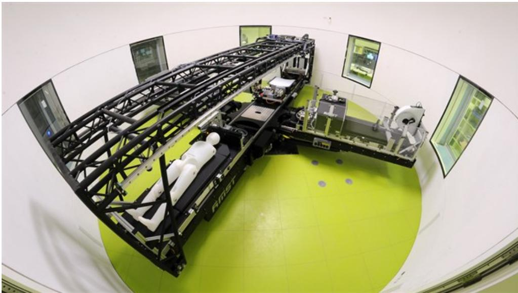
Die Kurzarm-Humanzentrifuge ermöglicht es, die Wirkung erhöhter Schwerkraft zu erforschen. (Bild: DLR)
