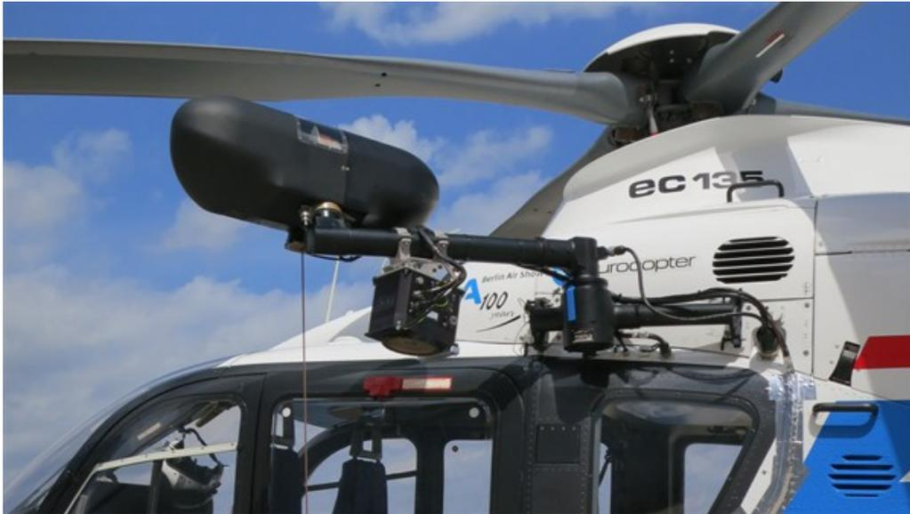
Der Sensor hilft bei der Stabilisierung und Positionierung der Außenlasten an Hubschraubern.
