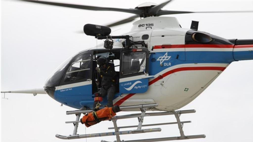
Der Flugversuchingenieur richtet die Außenlast, in Form einer Dummy-Puppe, aus.
