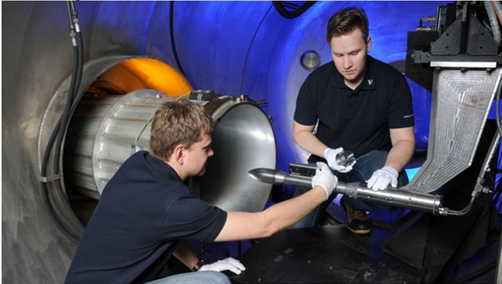
Die Ingenieure des Deutschen Zentrums für Luft- und Raumfahrt (DLR) bereiten das 75 Zentimeter große Modell einer Vega-Rakete für den Test im Windkanal vor. Dabei wird die Trennung von Ober- und Unterstufe simuliert, um die Strömungsveränderungen entlang der Rakete zu untersuchen.
