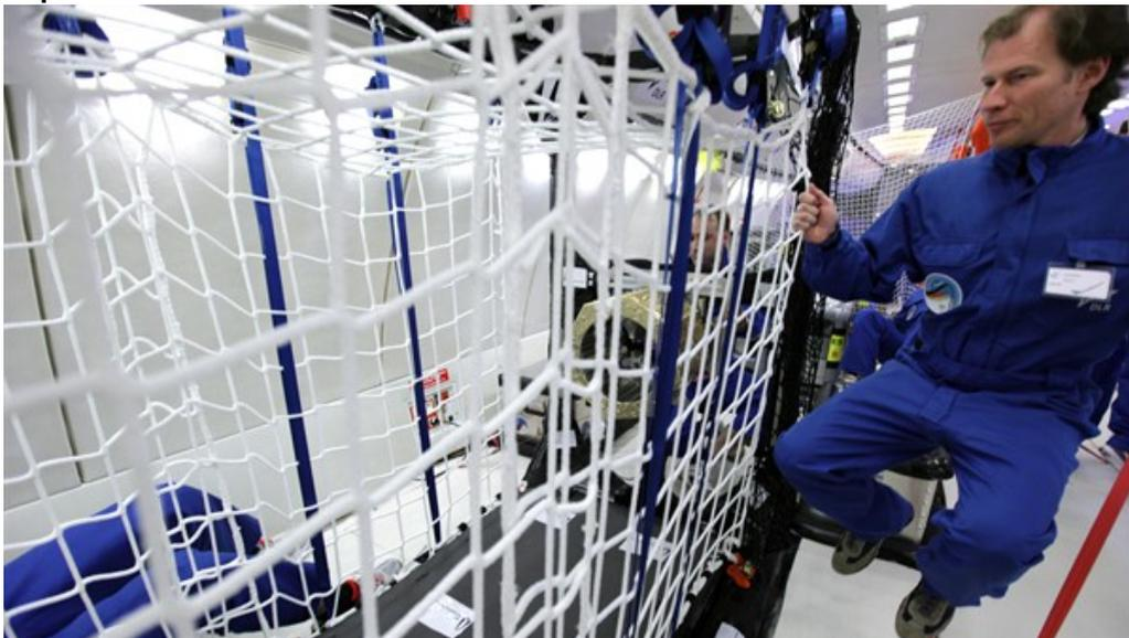
In einem mit Netzen abgesperrten Teil des Flugzeugs hatten die Entwickler vom Aerospace Institut aus Berlin ihr Technologie-Experiment installiert, um zu testen, wie sich Nano-Satelliten unter Schwerelosigkeitsbedingungen von einer Rakete separieren. In den Schwerelosigkeitsphasen wurde ein etwa hutschachtelgroßer Dummy-Satellit mehrfach horizontal ausgestoßen und in dem Sicherheitsnetz aufgefangen.
