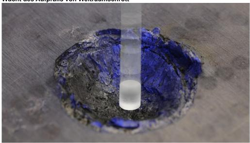
Das Foto zeigt einen Aluminiumblock, der bei einem Test am Ernst-Mach Institut in Freiburg von einem Kunststoffteil mit einer Geschwindigkeit von über sechs Kilometern pro Sekunde beschossen wurde. Dies verdeutlicht die Auswirkungen, die Treffer von bereits kleinen Teilen im Orbit auf Satelliten haben können.
