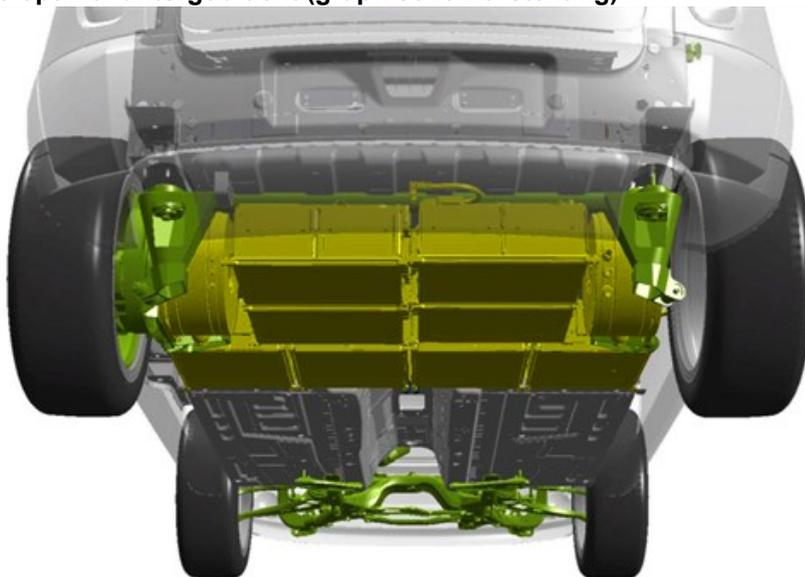
Ansicht des Demonstrators von unten - mit Batterie und elektrisch angetriebener Hinterachse.
