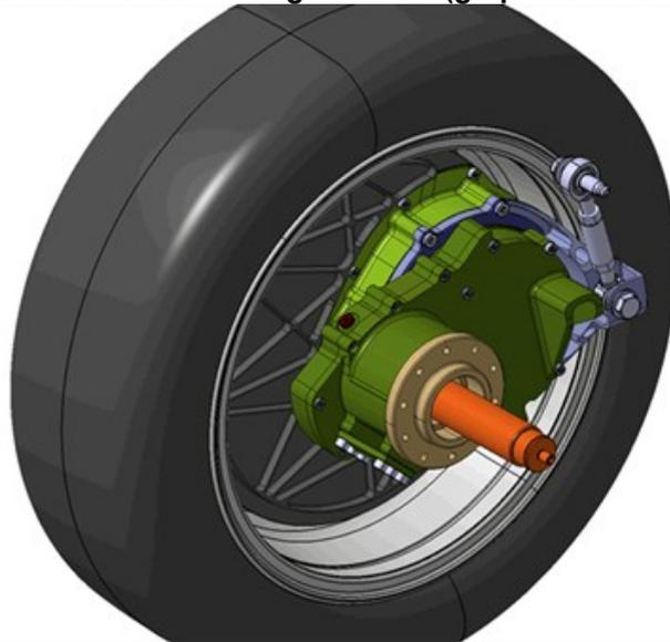
Ein vollkommen neuartiges In-Wheel-Getriebe ermöglicht die radnahe aber karrosseriefeste Anbringung der Elektromotoren (nicht im Bild) und übernimmt die Radführung und Aufbaufederung gleich mit.
