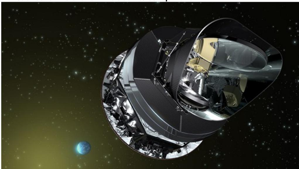
Das europäische Weltraumteleskop Planck wurde im Mai 2009 gestartet, um den Himmel mit zwei eigens dafür entwickelten Instrumenten bei neun Frequenzen zu durchmustern: das Low Frequency Instrument (LFI) umfasst die Frequenzbänder 30-70 Gigahertz und das High Frequency Instrument (HFI) die Frequenzbänder 100-857 Gigahertz. HFI stellte im Januar 2012 seinen Betrieb ein, während LFI weiterhin beobachtet.
