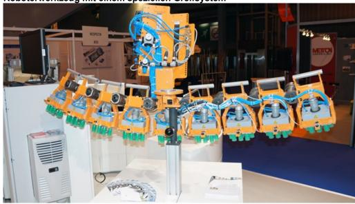
Der vom DLR sogenannte "Streifengreifer" kann sowohl einzelne streifenförmige Zuschnitte handhaben, als auch große Zuschnitte mit Hilfe von zwei kooperierenden Robotern. Durch seinen modularen Aufbau kann das Greifsystem an die Form des entsprechenden Bauteils angepasst werden.
