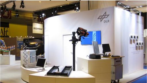
Ein optischer 3D-Scanner zur Vermessung und Bewertung der Flügelwelligkeit steht neben der im DLR entwickelten hochgenauen Flügelschale in CFK-Leichtbauweise.
