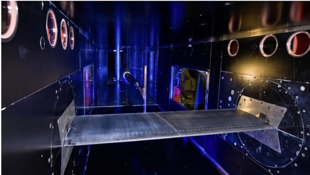
Modell eines Hubschrauber-Rotorblattes im Transsonischen Windkanal. Durch die Öffnungen an der Vorderkante wird Luft ausgeblasen, um die Aerodynamik zu verbessern.
