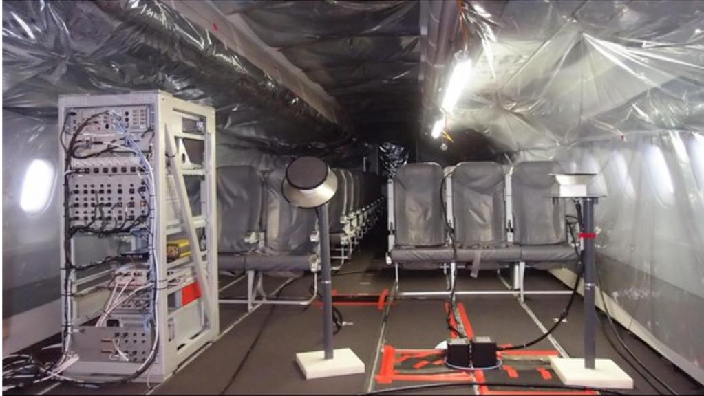
Auskleidung der Kabine des ATRA mit Absorberfolien.
