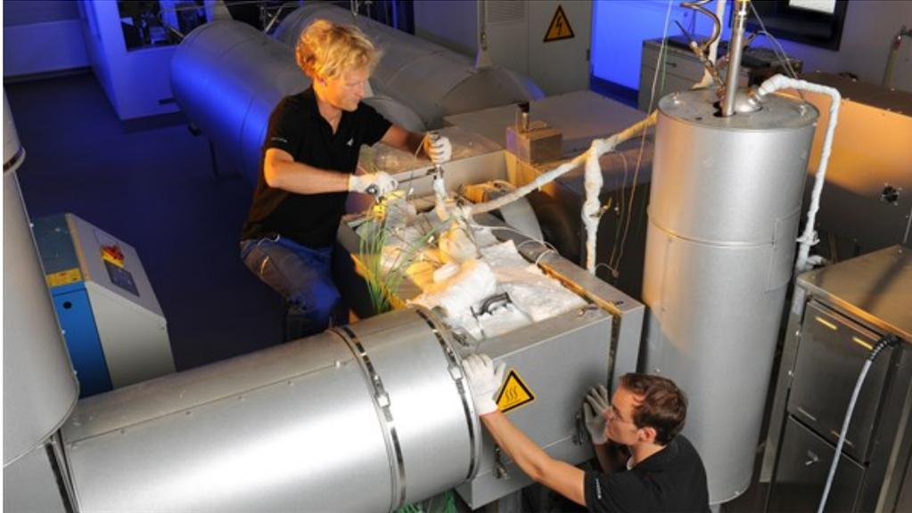
Thermochemische Wärmespeicher nehmen Wärme über endotherme Reaktionen auf und geben sie durch exotherme Reaktionen wieder ab. Sie haben eine sehr hohe Energiedichte und sind ideale Langzeit-Speicher. In der CWS Testanlage (Chemische Wärmespeicherung mittels reversibler Gas- und Feststoffreaktionen) im CeraStorE in Köln wird erstmals ein solcher Speicher in größerem Maßstab getestet.
