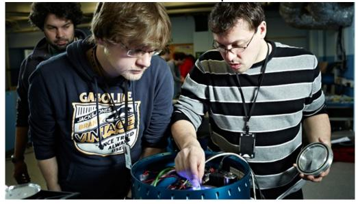
Die Studenten der TU Braunschweig treffen letzte Vorbereitungen am SPACE-Experiment, bevor die Rakete zusammenbebaut wird. Gleich wird der Vakuumbehälter, in dem sich die mit Staub gefüllten Versuchskammern befinden, zum letzten Mal verschlossen.
