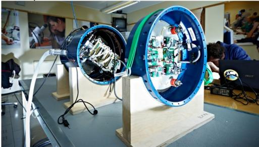
Beim Benchtest werden die Funktionsfähigkeit und das Zusammenspiel der Experimente mit der Raketentechnik getestet. Im Vordergrund sieht man das Experimentmodul SOMID, das an das Servicemodul von REXUS 12 angeschlossen ist. Das Servicemodul versorgt während des Flugs alle Experimente mit Strom und Funkverbindung.
