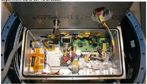
Innenansicht des Experiments CARU: Alle Komponenten befinden sich in einem rechteckigen, druckdichten Behälter.
