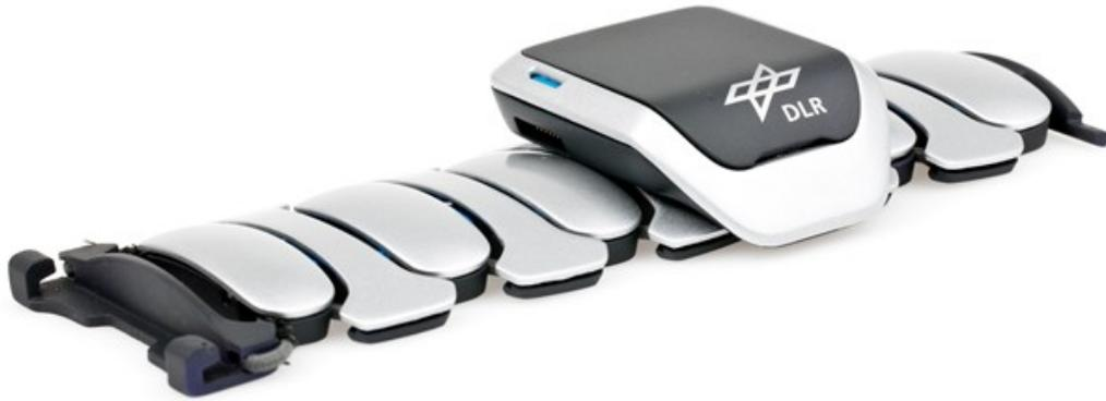
Durch sogenanntes vibrotaktilen Feedback, also mittels Vibration, werden Informationen vermittelt.
