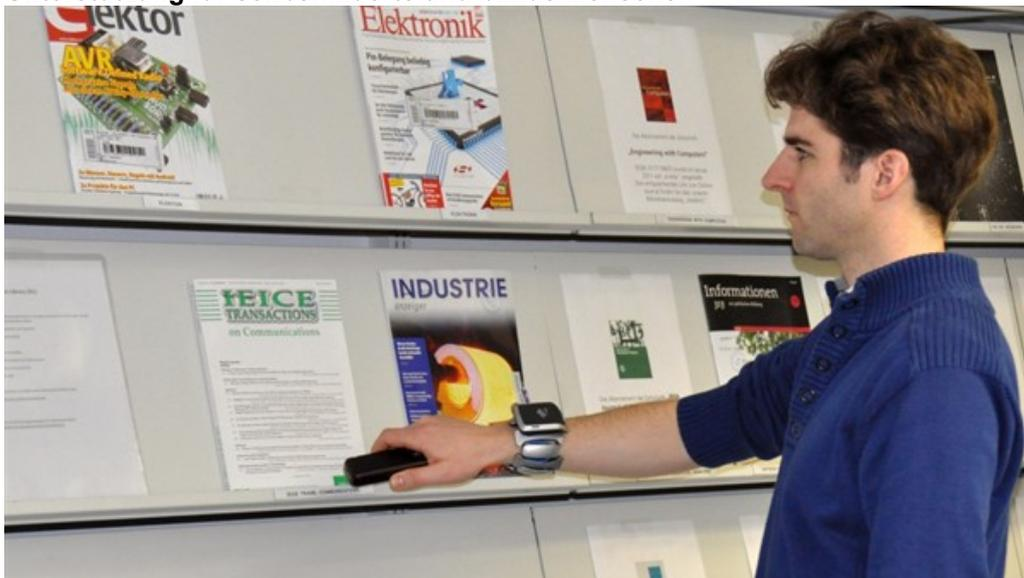
Durch die mit VibroTac darstellbaren Richtungs- und Entfernungshinweise kann die Hand des Nutzers zu einer bestimmten Zielposition geführt werden. Dadurch können Arbeitsplätzen für Blinde, wie beispielsweise eine Warenausgabe, optimiert werden.
