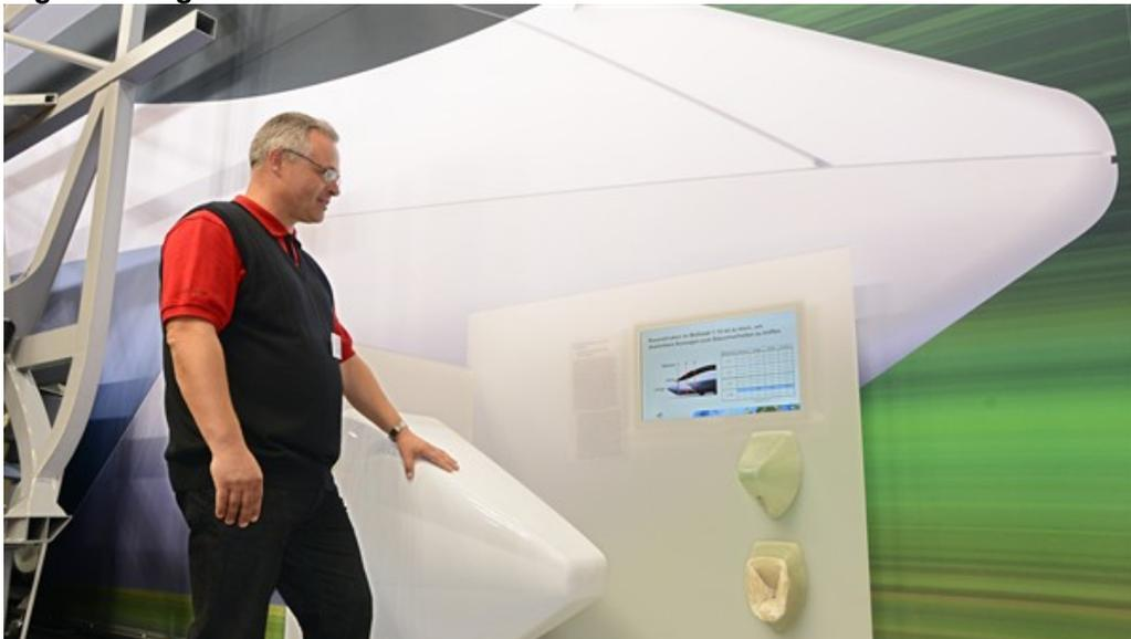
Die neuartige Fahrzeugnase aus glasfaserverstärktem Kunststoff faltet sich bei einem Aufprall nach innen zusammen. Sie dient als zusätzliches Crashelement.
