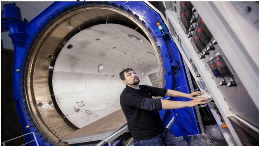
Neben seiner Fähigkeit als druckdichter Backofen unter Vakuum Faserverbundbauteile auszuhärten, ist der neue Autoklav auch Forschungsplattform. Neue Technologien und Prozesse für den Faserverbundleichtbau können hier entwickelt und getestet werden.
