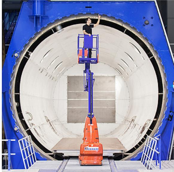
Der neue Autoklav im DLR-Stade ist 20 Meter lang und hat einen Durchmesser von nahezu sechs Metern.
