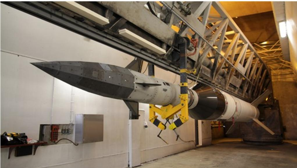
Im Launcher hängt der Raumflugkörper Shefex II des Deutschen Zentrums für Luft- und Raumfahrt (DLR) noch in der Waagerechten. Kurz vor dem Start öffnet sich das Hallendach, und die Startrampe richtet sich auf.
