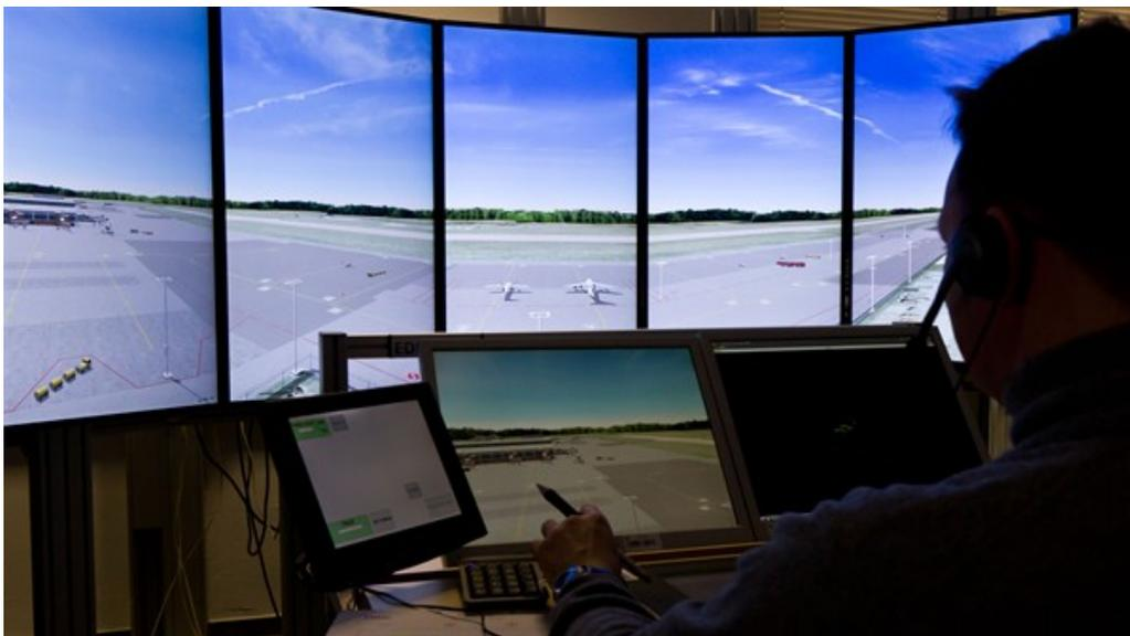
Der 360°-Towersimulator simuliert die Arbeits-Situation der Flughafenlotsen. Zusammen mit Lotsen der Flugsicherung sammeln die Forscher hier Daten, die später zu besseren Abläufen auf dem Rollfeld und beim Abflug führen sollen. Das neu aufgebaute "TowerLab" erweitert zudem den Towersimulator um eine laborartige Forschungsumgebung für Untersuchungen an neuen Konzepten und Verfahren der Flugsicherung, wie beispielsweise die Fernüberwachung von Flughäfen.
