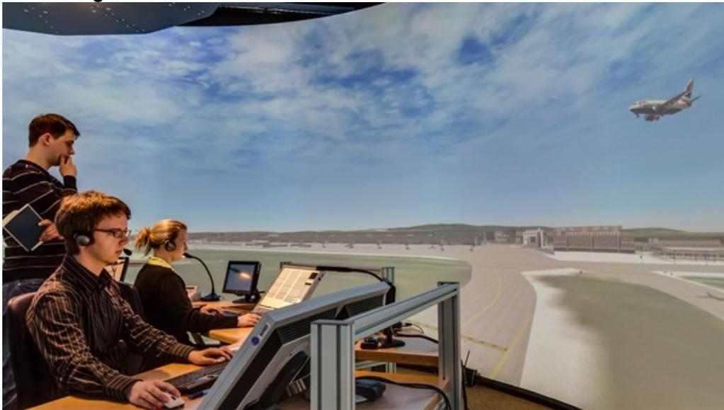
Im neuen "Validierungszentrum Luftverkehr" kann das DLR Ideen für einen besseren Luftverkehr untersuchen. Im Bild der Apron and Tower Simulator, ein Teil des neuen Zentrums.
