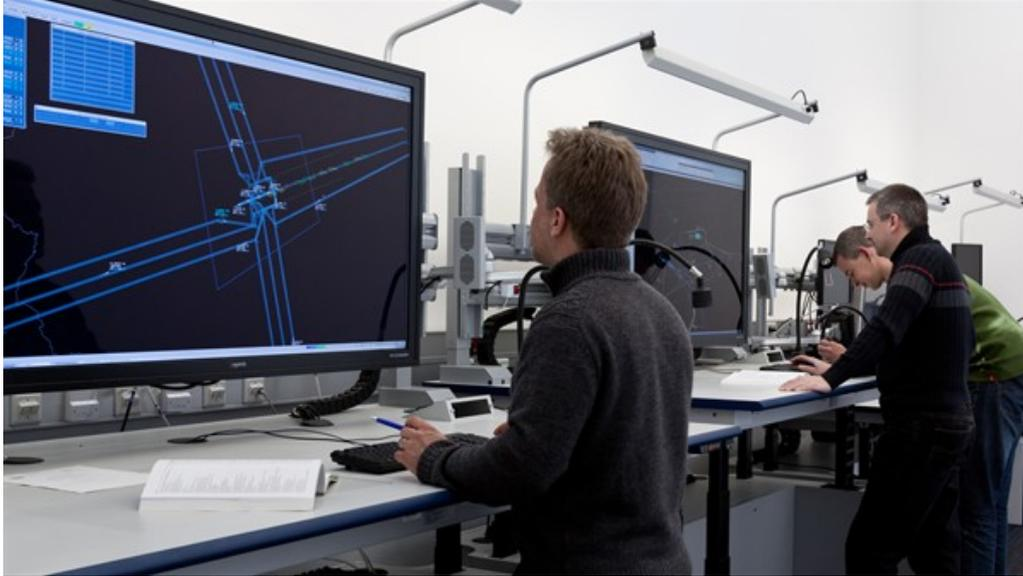
Der Radarsimulator ATMOS (Air Transport Management and Operations Simulator) stellt die Arbeitsplätze in einem Kontrollzentrum der Flugsicherung nach.
