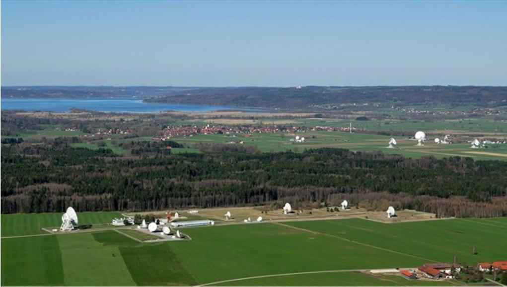
Die DLR-Bodenstation in Weilheim verfügt über mehrere Antennen, die sich auf einem 0,15 Quadratkilometer großen Gelände befinden. Die einzelnen Antennenkomplexe können unabhängig voneinander betrieben werden, d.h. es können gleichzeitig mehrere Missionen unterstützt werden (Multimissionsbetrieb).
