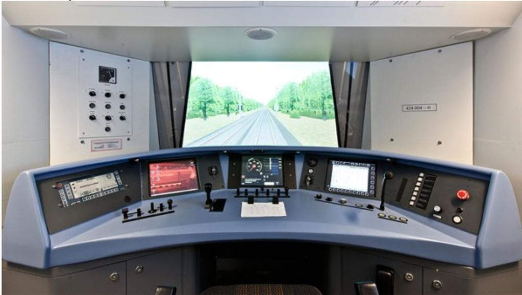
Im DLR-Bahnprüflabor "RailSiTe" können technische und betriebliche Tests für Zugfahrten simuliert werden. Es ist Anfang 2012 als bislang einziges Testlabor in Deutschland für Tests von ETCS-Komponenten akkreditiert worden.
