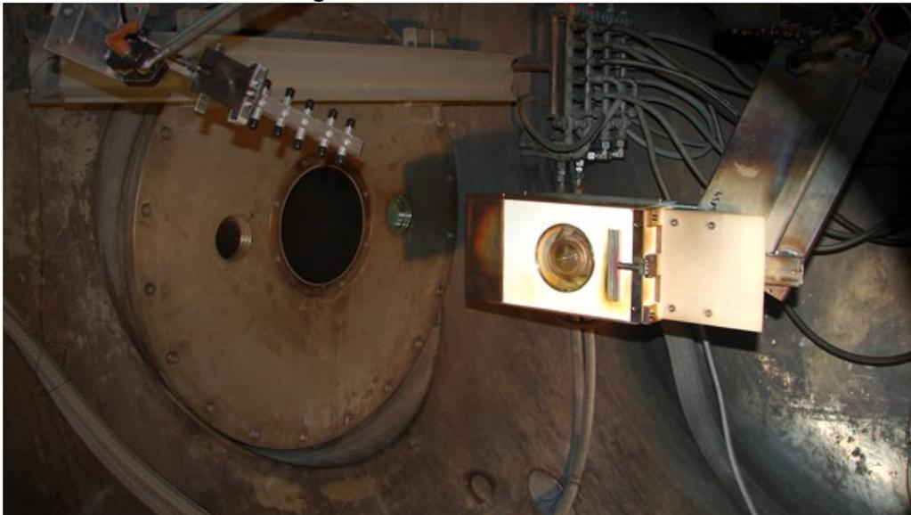
Bei den Tests im Lichtbogenbeheizten Windkanal der Abteilung Über- und Hyperschalltechnologie, des DLR-Instituts für Aerodynamik und Strömungstechnik, wird ein gekühlter Magnet in Kombination mit zwei Elektroden den Plasmastrom so verändern, dass die Funkwellen die reflektierenden Plasmaschichten durchdringen können. Die Magneten werden vom Karlsruher Institut für Technologie speziell entwickelt.
