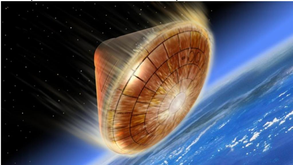
Während des Hyperschallflugs sowie beim Eintritt in die Erd- oder Marsatmosphäre besteht kein Kontakt zu dem Raumfahrzeug. Mitunter kann die Verbindung für mehrere Minuten unterbrochen sein.
