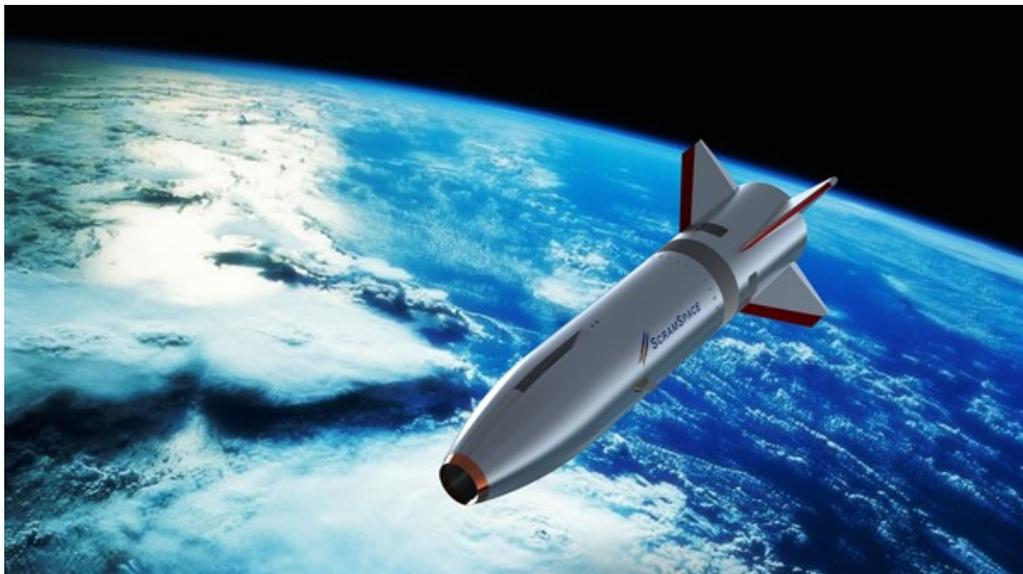
Illustration von SCRAMSPACE I: Das 1,8 Meter lange Raumfahrzeug wird von zwei Raketentstufen bis in 340 Kilometer Höhe transportiert. Nach dem Verlassen der Atmosphäre trennt sich der Scramjet von der Rakete, Steuerruder stabilisieren ihn bei der Rückkehr. Beim Rückflug beschleunigt das Fahrzeug bis auf Mach 8 – rund 8600 Kilometer pro Stunde. Der für die Wissenschaftler wichtige Teil des Experiments findet zwischen 32 und 27 Kilometern Höhe statt.
