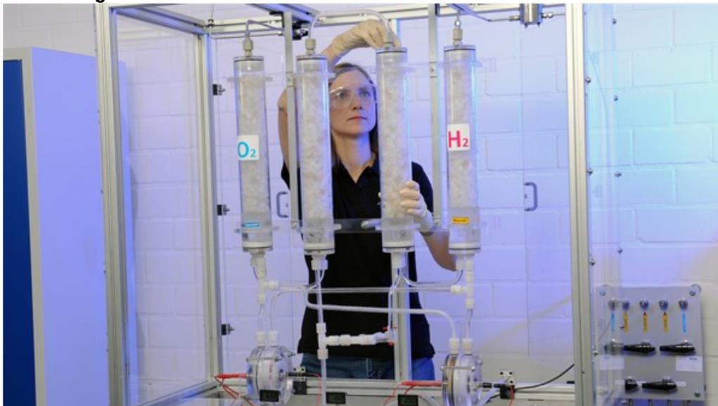
Elektrolyse-Teststand: im DLR entwickelte Elektroden für die alkalische Wasserelektrolyse. DLR-Forscher arbeiten an effizienteren Verfahren zur Herstellung von Wasserstoff durch die Elektrolyse.
