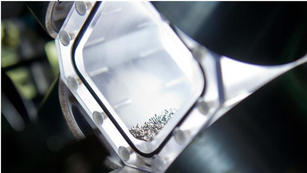
Das Granulat im Experiment MEGraMa-M: In der Schwerelosigkeit werden die Kügelchen dann im hell erleuchteten Probenbehälter schweben. Die runden Elektromagnete an allen vier Seiten setzen die Teilchen schlussendlich in Bewegung.
