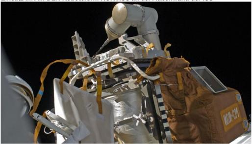
Knapp sechs Jahre lang war der DLR-Roboterarm ROKVISS an der Außenwand der ISS erfolgreich im Testeinsatz.
