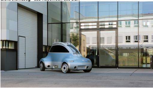
Wendig, leicht und - in Zukunft auch ganz schön selbstständig: das Robomobil, kurz ROMO genannt. Antrieb uns Bremse stecken im Rad. Das Elektromobil des DLR-Instituts für Systemdynamik und Regelungstechnik nutzt Techniken aus der Raumfahrt. Die Radroboter können einen Winkel von 90 Grad einnehmen und im Krabbengan seitlich fahren.
