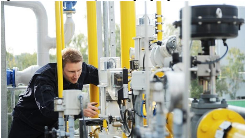
Der "LuVo3" wird mit Erdgas befeuert. An den Testständen können die Brennkammern mit unterschiedlichen Treibstoffen betrieben werden.
