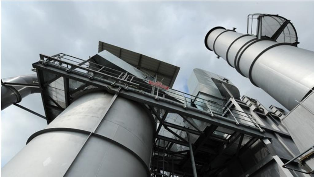
Der "LuVo3" ist einer der weltweit modernsten und leistungsfähigsten Lufterhitzer für den Versuchsbetrieb zur Brennkammerforschung.
