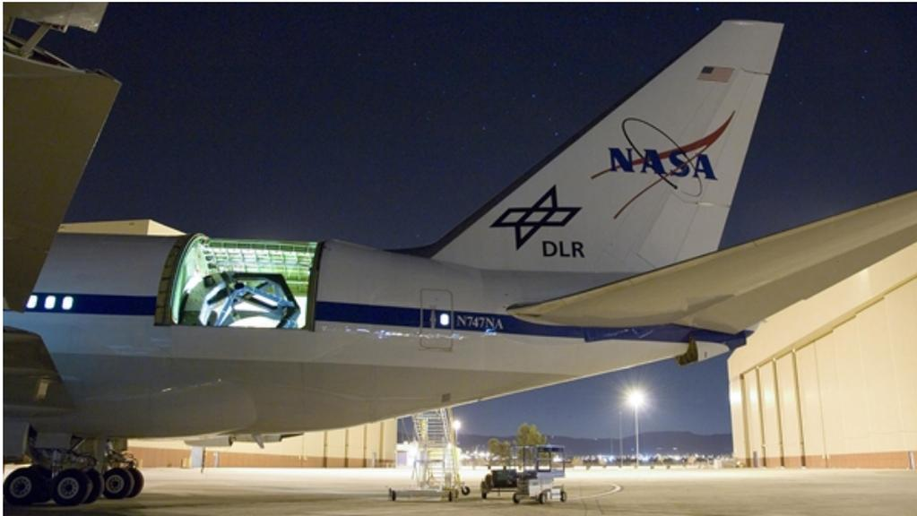
SOFIA während nächtlicher Testbeobachtungen des Sternenhimmels im März 2008. Die Öffnung im Rumpf der umgebauten Boeing 747SP gibt den Blick auf das in Deutschland gebaute 2,7 Meter-Infrarotteleskop frei.
