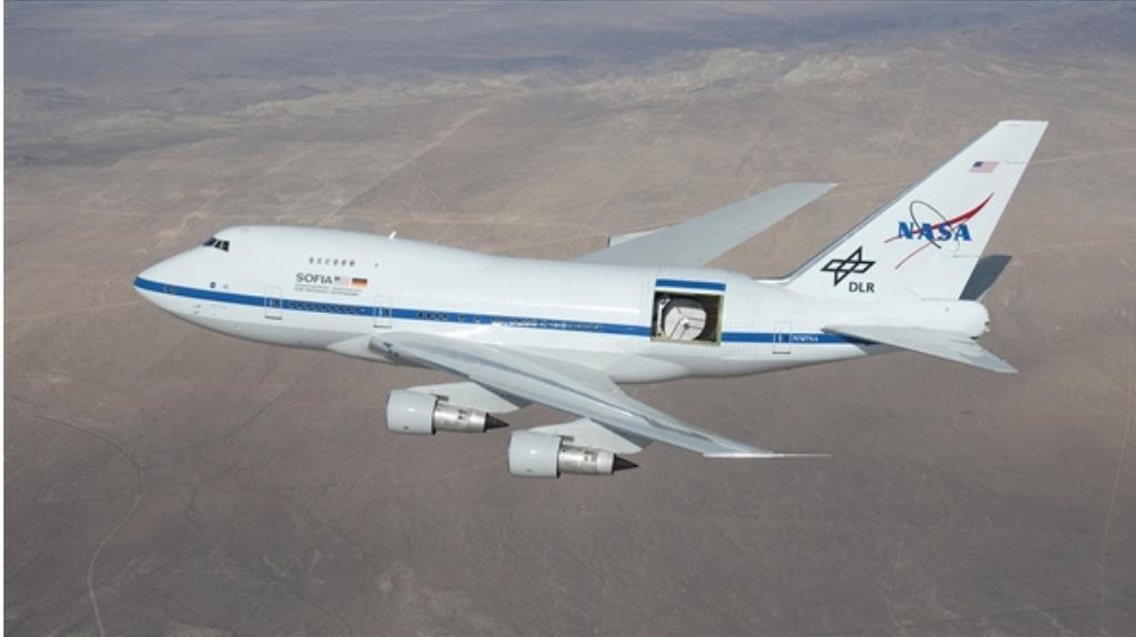
Das Stratosphären-Observatorium für Infrarot-Astronomie SOFIA während seines ersten Testflugs mit vollständig geöffneter Teleskoptür am 18. Dezember 2009 über der kalifornischen Mojave-Wüste. In der Öffnung im Rumpf der Boeing 747SP wird das in Deutschland gebaute 2,7 Meter-Teleskop sichtbar. Der Testflug mit geöffneter Tür ermöglichte den Ingenieuren zum ersten Mal, die Luftbewegungen in und um Teleskop und Tür experimentell zu untersuchen.
