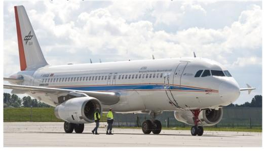
Das DLR-Forschungsflugzeug ATRA bei den Versuchen, ausgestattet mit einem elektrischem Bugrad, angetrieben durch eine Brennstoffzelle.
