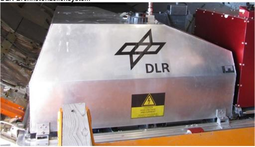
Das DLR-Brennstoffzellensystem eingebaut in das Forschungsflugzeug ATRA.
