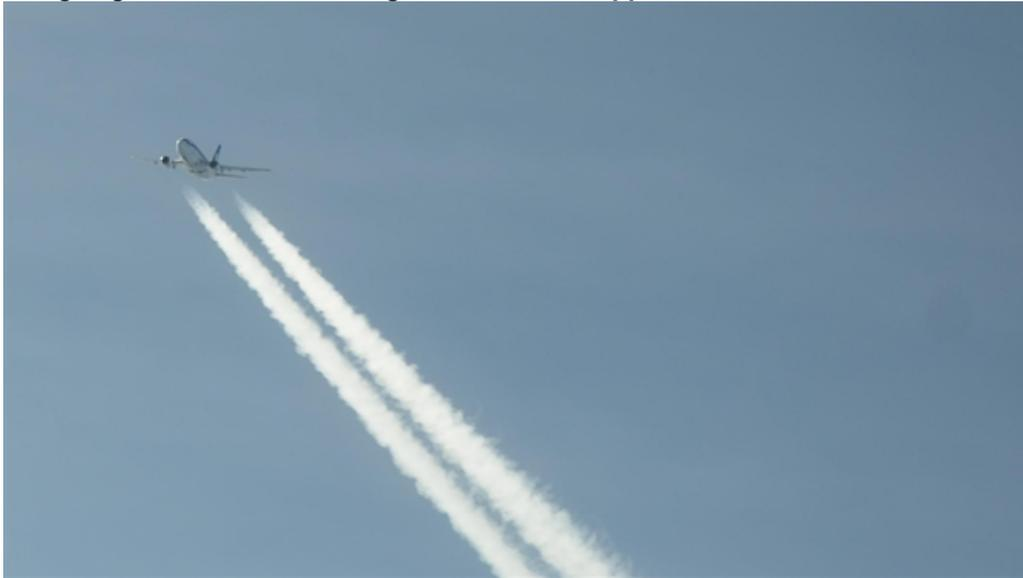
Da sie eine geeignete Visualisierung der beiden Einzelwirbel einer Wirbelschleppe darstellen, war eine gute Sichtbarkeit der Kondensstreifen im Reiseflugbereich oberhalb von 10000 Metern Voraussetzung für die Durchführung der Versuche. Vorhergesagt wurde die Kondensstreifenbildung mittels des Schmidt-Appelmann-Kriteriums von den Experten des DLR-Instituts für Physik der Atmosphäre.
