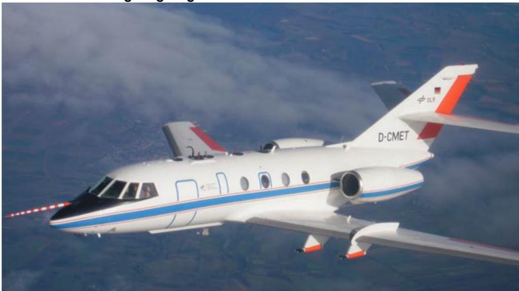
Das DLR-Forschungsflugzeug Falcon 20E wurde als geeignetes Messflugzeug ausgewählt. Die Falcon verfügt über eine komplette Messinstrumentierung zur Erfassung der Flugdynamik und einen Nasenmast, an dem vor dem Flugzeug in ungestörter Strömung lokale Anströmwinkel erfasst werden.
