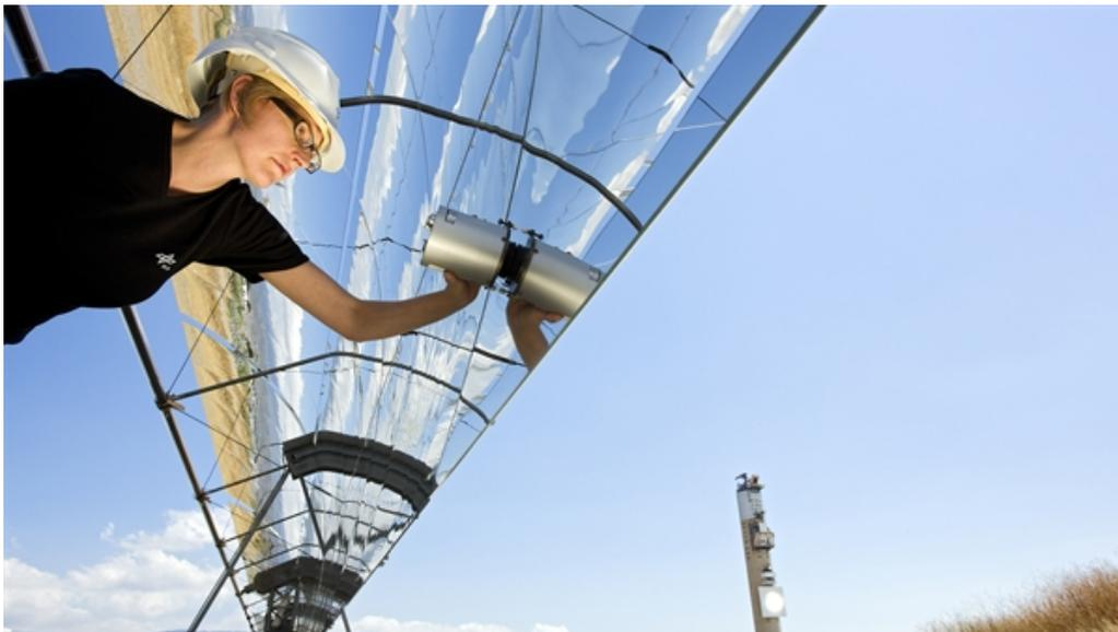
DLR-Forscherin in Almeria prüft die Reflexionseigenschaften eines Parabolspiegels. Parabolrinnen werden bereits in großen solarthermischen Kraftwerken eingesetzt. Die Forscher arbeiten nun an einer besseren Effizienz, geringerer Wartungsintensität und einer längeren Lebensdauer der einzelnen Bauteile.
