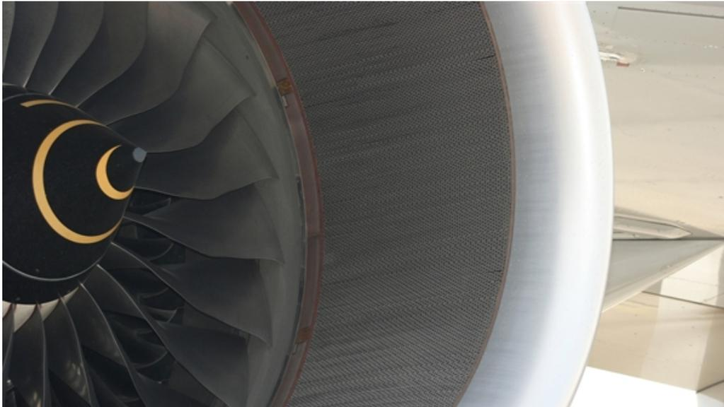
Die gestrichelte Fläche stellt den Bereich des Liner-Bauteils dar - beispielhaft am Einlauf eines Triebwerks.
