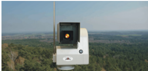
FireWatch im Einsatz in Brandenburg. Bild: IQ wireless.
