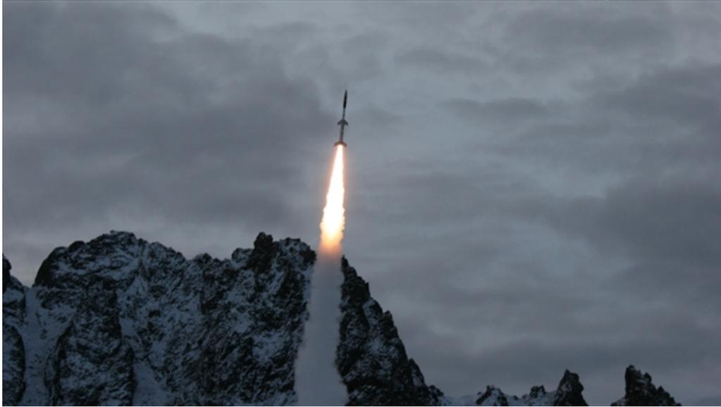
Nach dem Start erreichte SHEFEX I über dem Nordmeer eine Höhe von 211,5 Kilometer und trat mit fast siebenfacher Schallgeschwindigkeit wieder in die Erdatmosphäre ein. Bei SHEFEX II soll elffache Schallgeschwindigkeit erreicht und die Wiedereintrittsphase auf bis zu 60 Sekunden erweitert werden.
