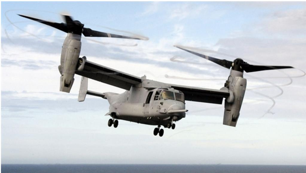
Sichtbare Wirbel: In dieser Aufnahme sind die Wirbel, die sich an den Enden von Rotorblättern bilden, gut zu sehen.
