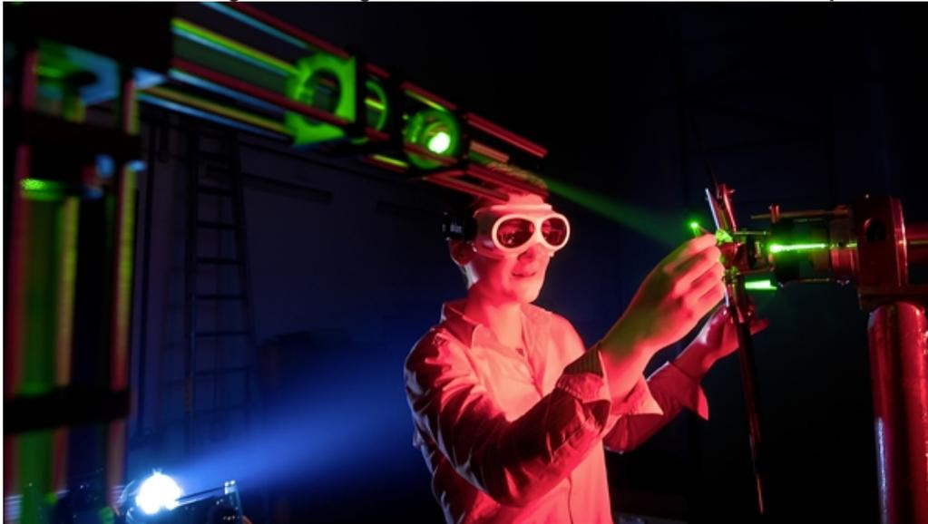
Mit Laser und Hochgeschwindigkeitskameras dem Rotor-Lärm auf der Spur: Dr. Karen Mulleners vom DLR Göttingen justiert das Modell eines Hubschrauberrotors für die Messung.
