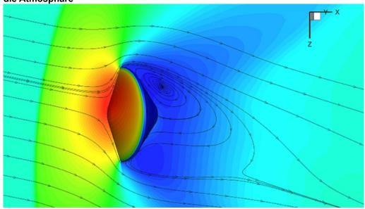
Eine genaue Vorhersage der Verteilung des Hitzeflusses auf der Oberfläche der Raumkapsel, die mit Hyperschall in die Atmosphäre eintritt, ist für eine grundlegende Verbesserung der Eintrittstechnologie unerlässlich. Zur Modellierung der Strömungsverteilung werden vielfach Computersimulationen eingesetzt. Die Daten für diese Computermodelle stammen aus Windkanalversuchen, bei denen die physikalischen Eigenschaften des Mars nachgebildet werden.
