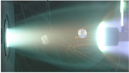
Die Daten für die numerischen Computermodelle stammen aus Windkanalversuchen, bei denen die physikalischen Eigenschaften des Mars nachgebildet werden. In der Marsatmosphäre befinden sich beispielsweise mehr Partikel als in der Erdatmosphäre, was einen höheren Reibungswiderstand bedeutet.
