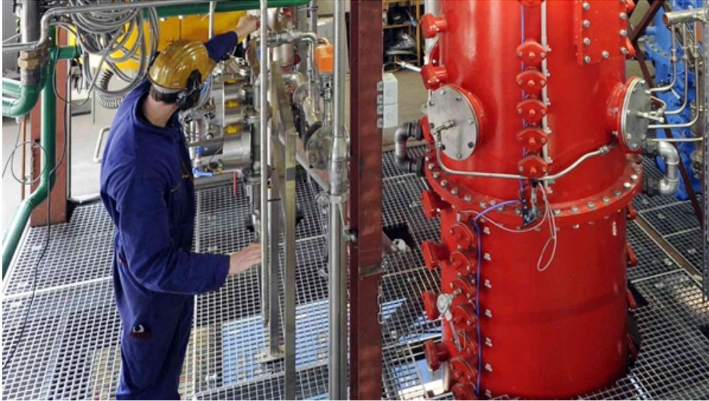
Pilotanlage an der Universität Stuttgart zur Untersuchung der Synthesegasherstellung.
