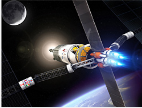
Konzept eines Raumfahrzeugs mit vier VASIMR-Triebwerken
