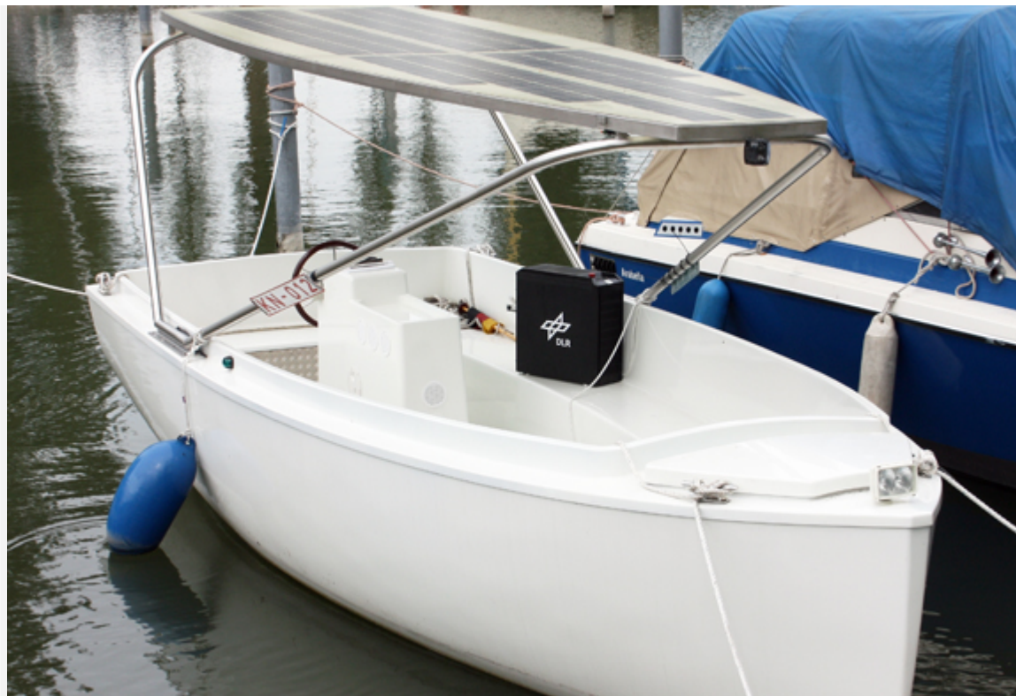
Solarboot der Firma Kopf Solarschiff mit neuem DLR-Brennstoffzellensystem
