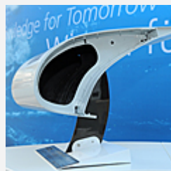
Besonders belastbar: Flügel-Vorderkanten aus CFK
