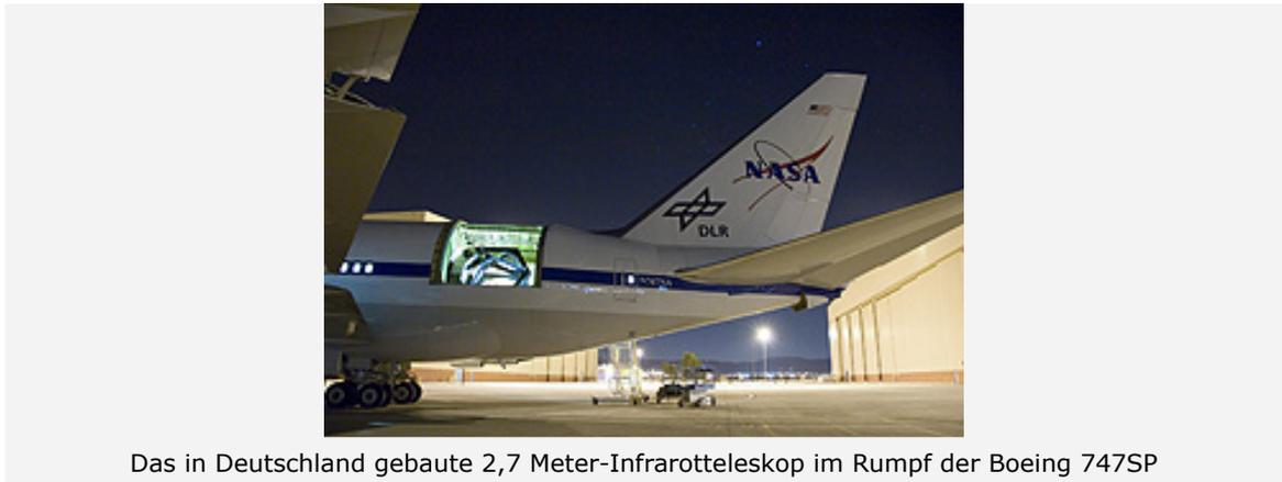
Das in Deutschland gebaute 2,7 Meter-Infrarotteleskop im Rumpf der Boeing 747SP
