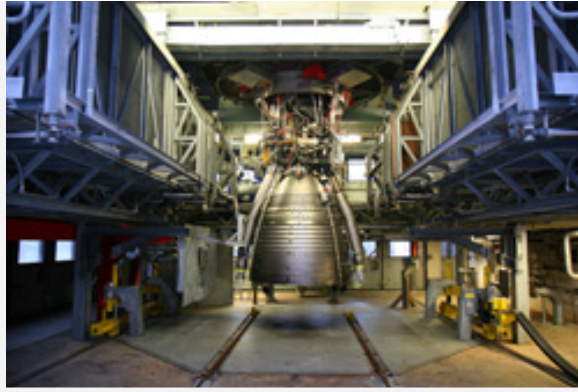
Neu entwickelte Schubdüse NE-X erstmals auf dem Prüfstand beim DLR Lampoldshausen.
