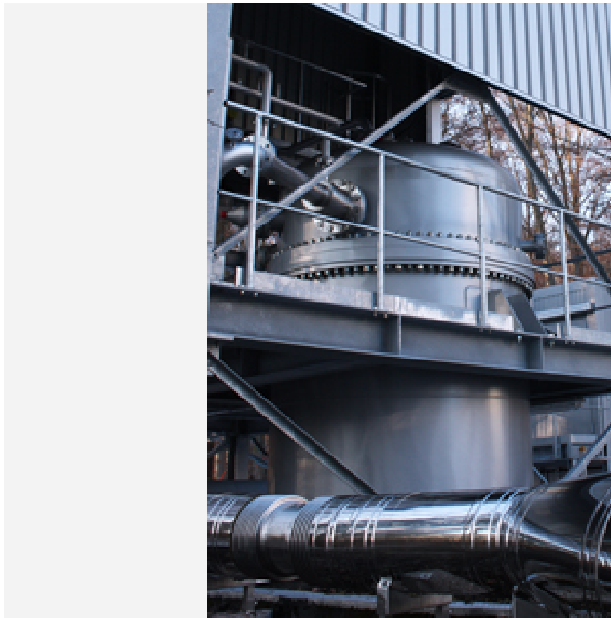
Teststand zur Untersuchung von Hochtemperaturspeichern
