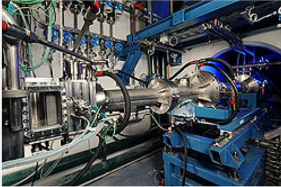
Das Herzstück des Prüfstands: die Brennkammer
