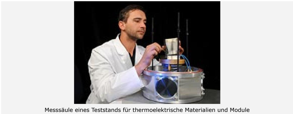
Messsäule eines Teststands für thermoelektrische Materialien und Module
