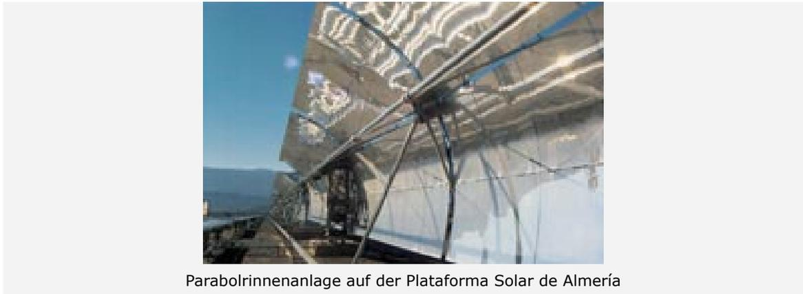
Parabolrinnenanlage auf der Plataforma Solar de Almería
