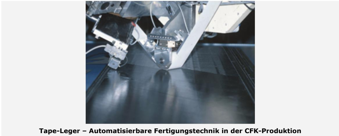
**Tape-Leger – Automatisierbare Fertigungstechnik in der CFK-Produktion**
