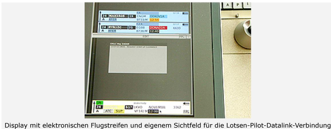
Bei den aktuellen Tests steht zum ersten Mal die Rollführung mit Hilfe der so genannten "Controller Pilot Data Link Communication" im Mittelpunkt. Mit diesem Verfahren kommuniziert der Pilot im Flugversuchsträger ATTAS nicht mehr über Sprechfunk, sondern über einen elektronischen Datenlink mit dem Fluglotsen. Solche Versuche gab es bisher nur im Streckenflug, der weniger zeitkritische Einzeloperationen erfordert.
