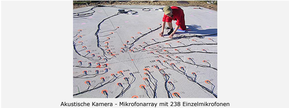
Akustische Kamera - Mikrofonarray mit 238 Einzelmikrofonen
